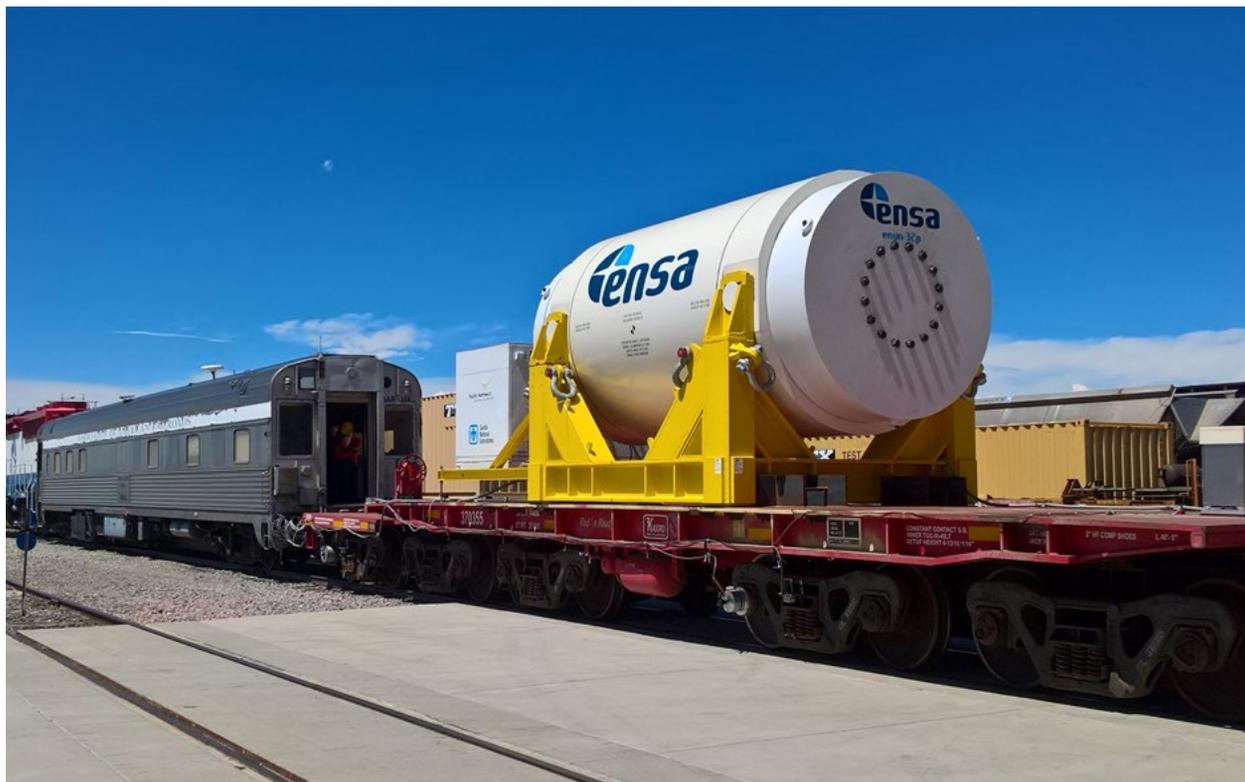
Contenedor ENUN 32P durante los ensayos de transporte realizados en EE.UU.
